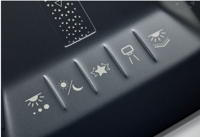
Bild 1. Die organische 3D-Verformung der Oberfläche der Konsole unterstützt bei der intuitiven Bedienung der Touchbuttons.
